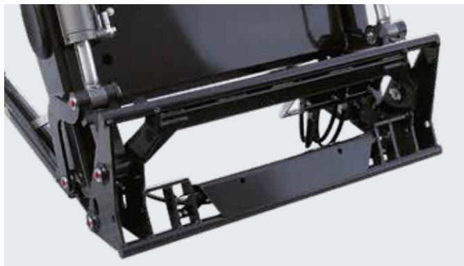
Werkzeugverriegelung auf Knopfdruck, noch bequemerer Werkzeugwechsel ohne abzusteigen – mit HYDRO-LOCK.
