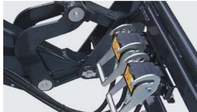
Werkzeug Fix 2-fach Kupplung für den 3. und 4. Steuerkreis.
